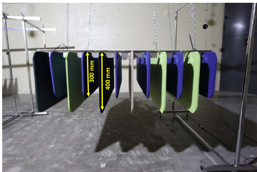
1 objet = 1 élément de grilles avec 12 lames alternées de 1200 x (400/300)mm
