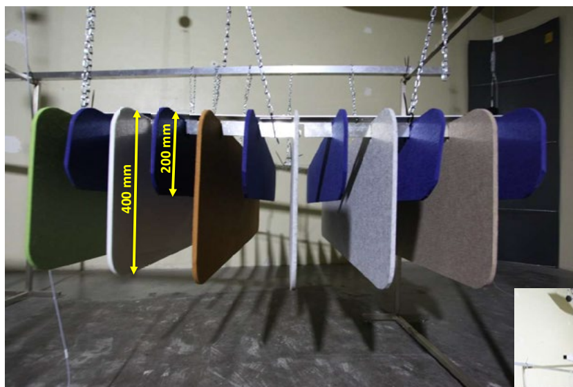
1 objet = 1 élément de grilles avec 12 lames alternées de 1200 x (400/200)mm
