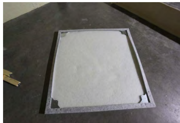
photo : Intérieur de la SlimBox ilôt plafond (1060 x 1060 x 42 mm) avec le molleton PE (+/- 533 g/m 2 , épaisseur +/- 22,5mm)
