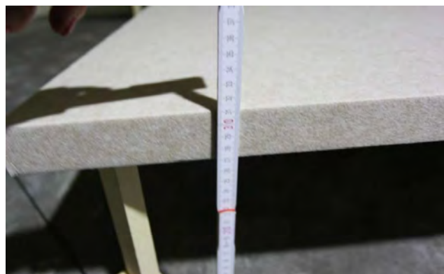
photo : vue latérale de l'objet testé : l'ilot de plafond des supports en bois d'une hauteur de 270 mm
