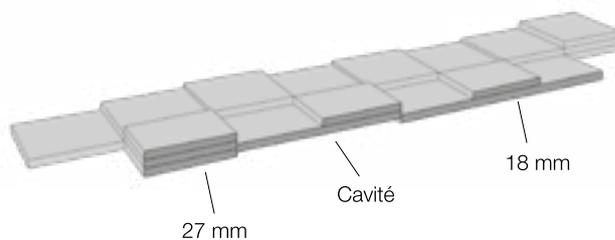
Structures en 3D avec des cavités invisibles pour optimiser l'absorption acoustique
