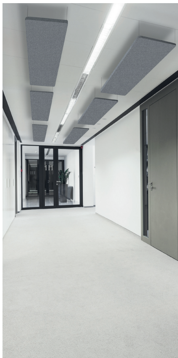
AirPanel 1 cara 1200 x 600 mm, suspendidos por eslingas
